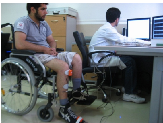
شکل ۲. فرد دچار ضایعه نخاعی در حال آزمایش کنترل حرکت مفصل مچ پا با استفاده از عضلات بازکننده و جمع کننده
